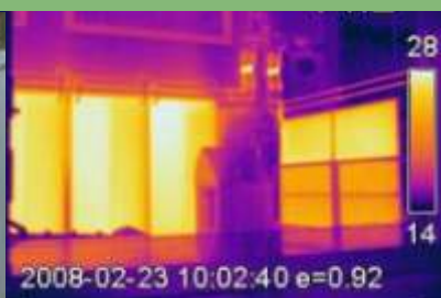
Panelli radianti per riscaldare e raffreddare, 385 m 2
